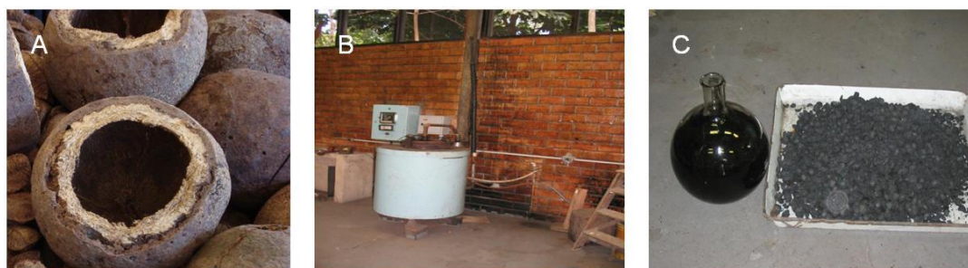
Figura 2. A) Ouriço total, B) Biocarbonizador, C) Biocarvão (Gama, 2019).
